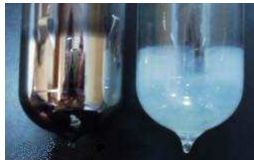
Le bout du tube est argenté si le vide est effectif, sinon il devient blanc
