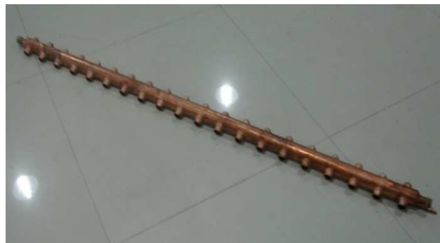
Collecteur en cuivre rassemblant les pipes de chaleur
